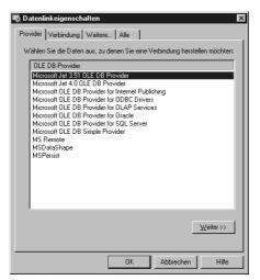
Bild 4.4: In diesem Dialogfeld wird der OLE DB-Provider ausgewählt
