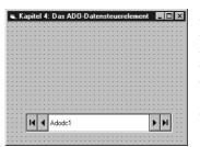
Bild 4.2: Das ADO-Datensteuerelement wurde auf dem Formular angeordnet
